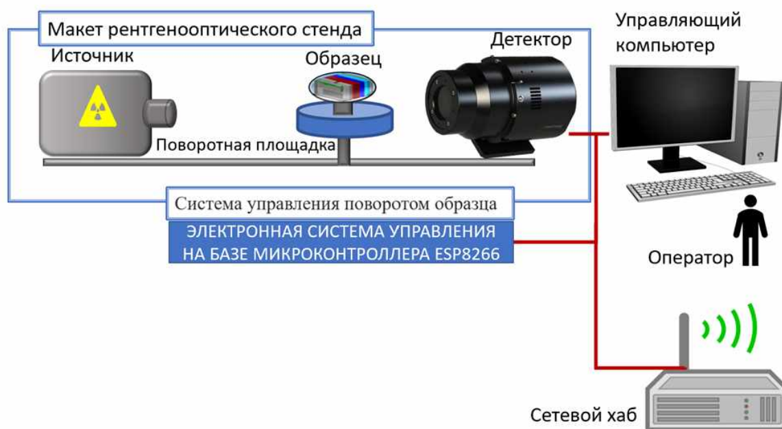
Рис. 2. Структурная схема экспериментальной установки для томографии.
